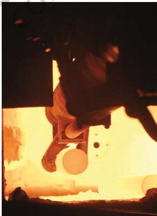
1 A look through the door into the flameless oxyfuel-fired rotary hearth furnace at ArcelorMittal Shelby Blick durch die Tür in einen flammenlosen, Oxyfuel-befeuerten Drehherdofen bei ArcelorMittal Shelby, USA
